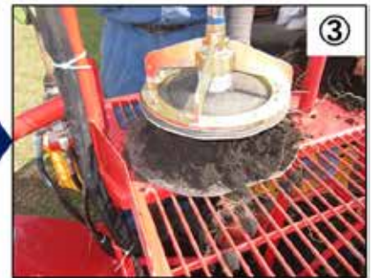
③ ポキ音まで押圧 ※音発生時で70%以上分離しています
