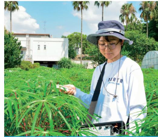
キャッサバ個葉の蒸散速度の測定
