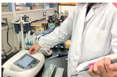
酵素法による糖の選択的定量
